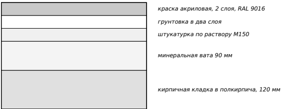
Узел 3. Стена служебного помещения
