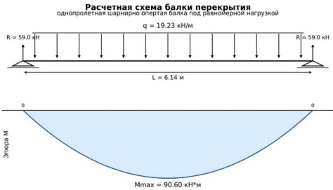
Расчетная схема балки перекрытия
